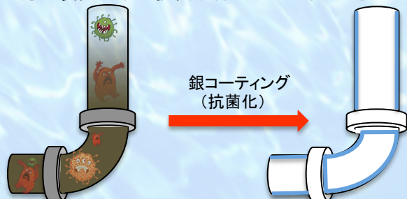
図2 配管内部に抗菌成分がコーティングされる模式図
